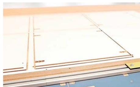
*/ Für die Nesting-Anwendung wurde die Speed-Serie entwickelt. Es gibt sie in vier Ausführungen mit Bearbeitungsbereichen bis 3000 x 2100 mm.*
