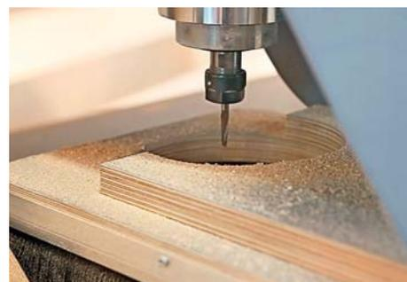
*/ Der pragmatische Ansatz sieht die Teilebearbeitung mit nur einem Werkzeug vor. „1-Fräser-Prinzip“ nennen das die Macher der CNC-Holzfräse.*
