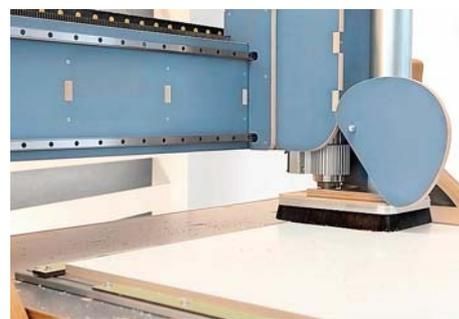
*/ Die x- und y-Achse arbeiten mit Zahnstangen und Planetengetriebe, für die Bewegung in z-Richtung sorgt eine Kugelumlaufspindel.*
