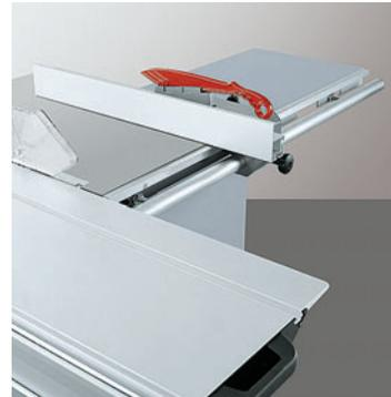
Der Parallelanschlag, präzise und leichtgängig.
