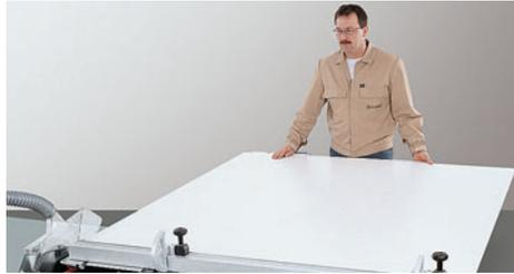
Die Platte ausrichten und einen Besäumschnitt durchführen.
