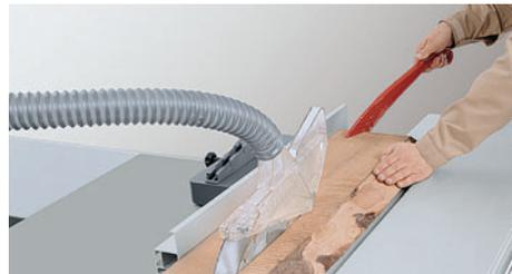
Werkstück am Parallelanschlag entlang durch das rotierende Sägeblatt führen, ggf. mit Hilfe des Schiebbestocks.
