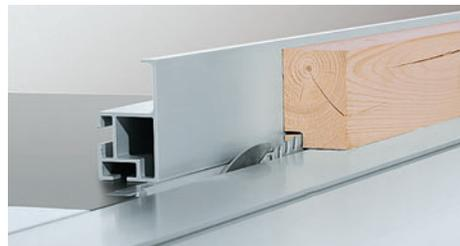
Die Spaltkeilhöhe 2 mm unterhalb des Sägeblattzahns einstellen und den Parallelanschlag hinter dem Sägeblatt positionieren.
