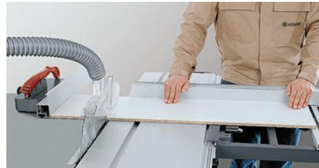
Plattenstreifen am Parallelanschlag auf Fertiglänge schneiden.
