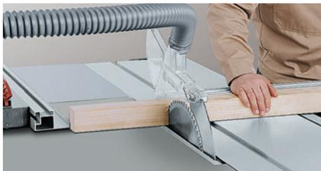
Den Parallelanschlag vor dem Sägeblatt positionieren, auf Maß stellen und ablängen.
