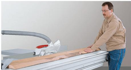
Das Material entlang der Schnittlinie ausrichten und besäumen.
