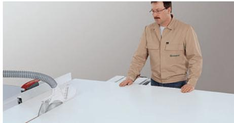
Plattenstreifen am Parallelanschlag aufschneiden.
